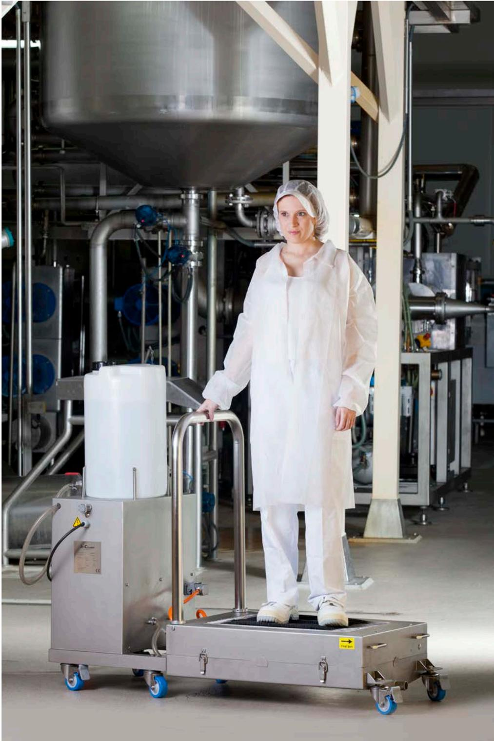
Schuhsohlen- Reinigung mit Sprühdesinfektion
